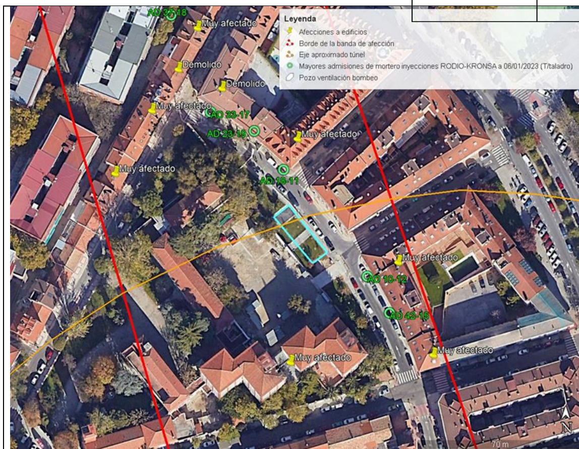
Figura 2. Mayores admisiones de inyección (verde) relacionadas con las afecciones a edificios . Las líneas en color rojo delimitan la zona de máxima afección.
