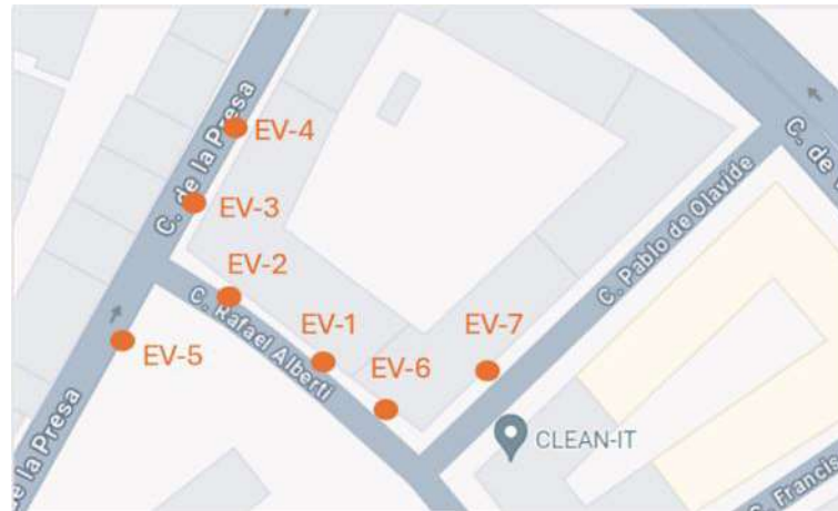
Figura 28. Ubicación de los extensómetros de varillas instalados
